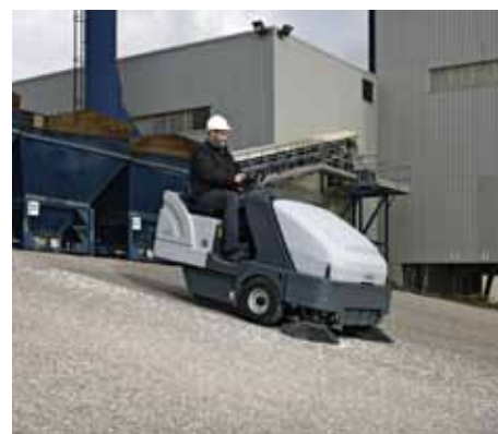
La spazzatrice Nilfisk SR 1601 supera pendenze fino al 25% (versione a gasolio Motore Kubota 3Cilindri)
