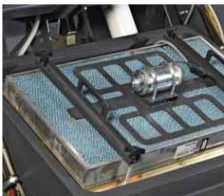
Il sistema scuoti filtro brevettato (a frequenza armonica variabile) garantisce l'ottimale pulitura del filtro in tutte le sue parti
